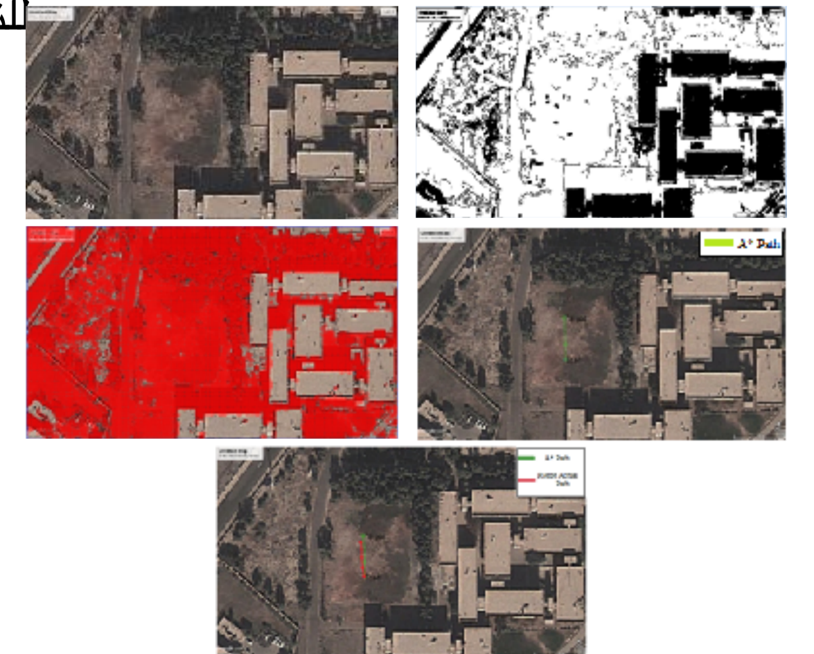
نتائج مسار الروبوت المتنقل على خريطة الأقمار الصناعية باستخدام خوارزمية A*
